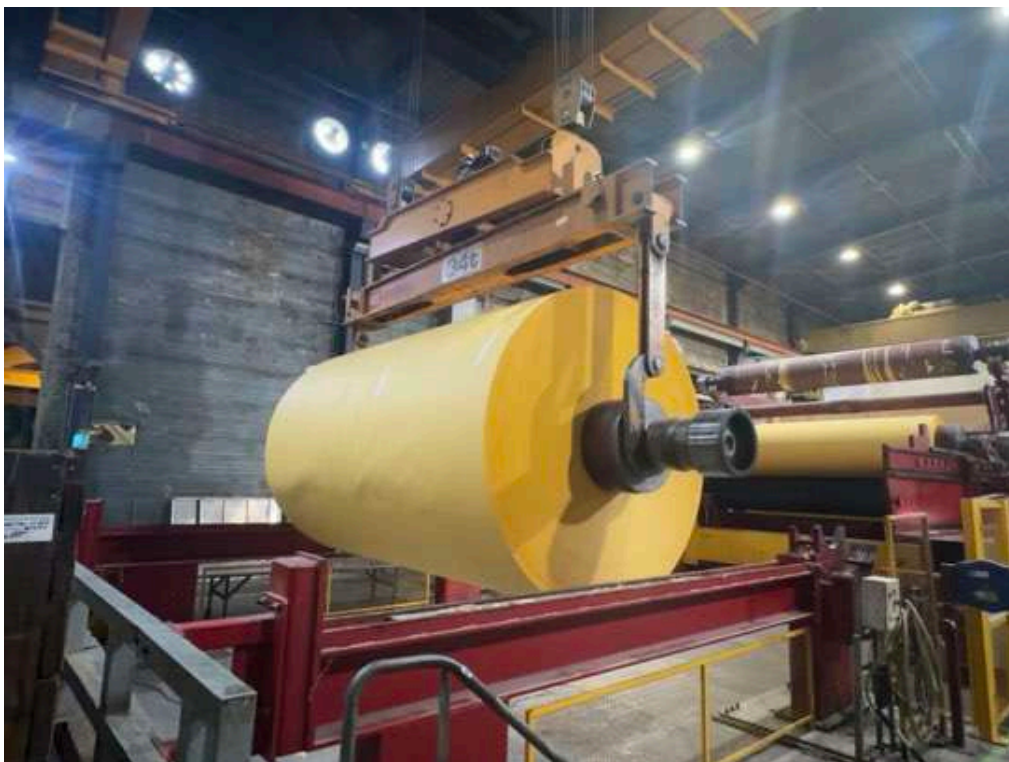
Enlèvement au palan de 34 tonnes de la bobine mère
