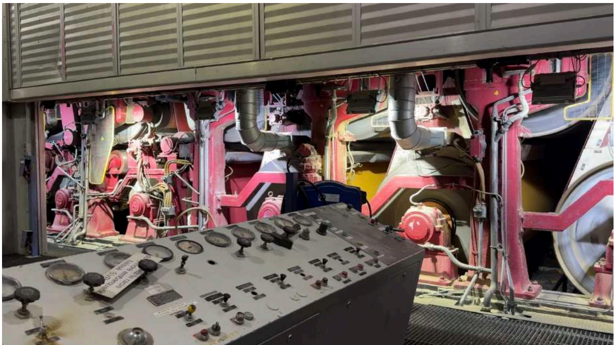
Pupitre de commande pour le contrôle des cylindres en arrière plan
