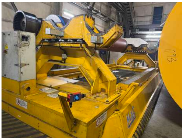
Chariot automatisé sur rails (transport entre machine à papier et super-calandres)
