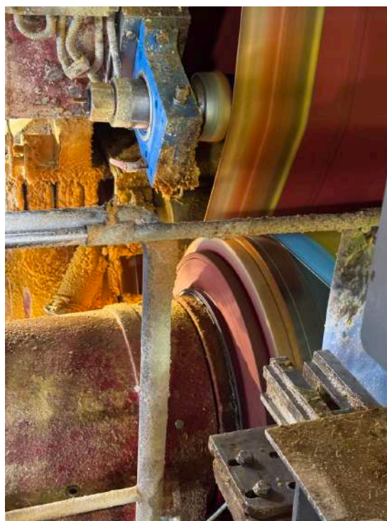
Détail du cylindre aspirant en bout de table de formation (Couch roll)
